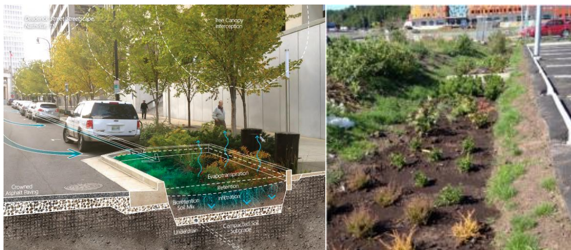
Figur 4. Princip och exempel på ett s.k. biofilter vilket används för att fördröja och rena dagvatten på naturlig väg. Källa: Aalto-universitet., Sweco.
