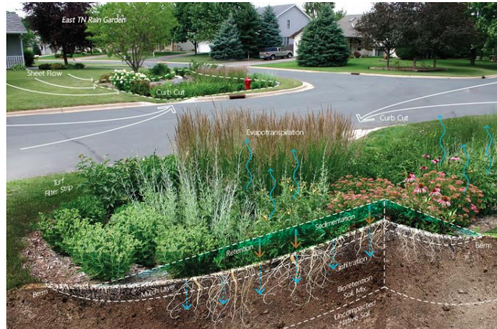
Figur 3. Princip för växtbädd eller regngård, som bidrar till fördröjning och naturlig rening av dagvatten på lite längre sikt. Källa: Aalto-universitet.
